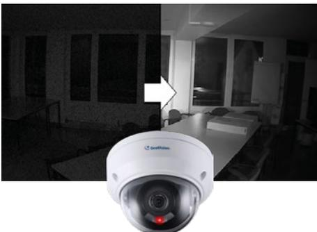
Bei schlechten Lichtbedingungen, zum Beispiel nachts, schaltet die Kamera automatisch in den Schwarz/Weiß-Betrieb um. Die Sicht wird zusätzlich durch die integrierte Infrarotbeleuchtung unterstützt. Die Kamera besitzt einen eingebauten Infrarot-Sperrfilter (IR-Cut-Filter). Damit werden störende Einflüsse der IR-Strahlung auf die Abbildungsqualität des Sensors vermieden.
